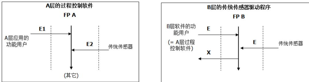
图 3.10 (a) 和 (b)-由过程控制软件层的软件 A 发送一组传统传感器到传统传感器设备驱动层的软件 B 进行处理的解决方案
